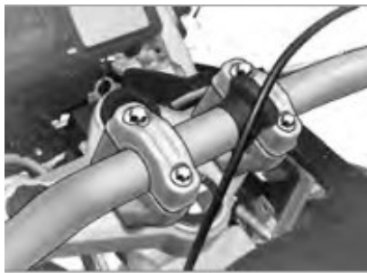
Figuur 1 Originele positie stuurstropen
