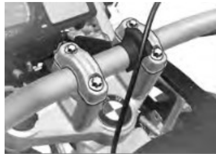
Figuur 2 Stuurstropen 180 graden gedraaid
